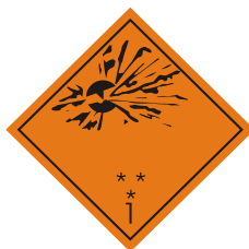
(č. 1) Podtřídy 1.1, 1.2 a 1.3 Symbol (vybuchující puma): černý; podklad: oranžový; číslice "1" v dolním rohu
